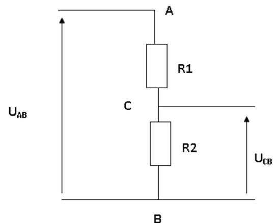
Le rapport  $\frac{R_2}{R_1+R_2}$  est compris entre 0 et 1, donc  $U_{CB}$  est une partie de  $U_{AB}$ . On appelle ce montage «diviseur de tension ». il permet d'obtenir une tension de sortie  $U_{CB}$  réglable par la tension d'entrée  $U_{AB}$  selon la relation
